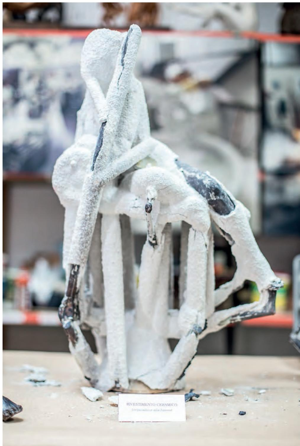
Sulla forma in cera viene effettuato un rivestimento ceramico finissimo che garantisce una grande fedeltà di riproduzione ed è, allo stesso tempo, refrattario, resistendo alle alte temperature ed alla pressione del metallo fuso. Si procede immergendo le forme in cera ripetute volte in un bagno ceramico liquido fino ad ottenere lo spessore ceramico sufficiente a resistere, dopo la cottura, al metallo fuso.
