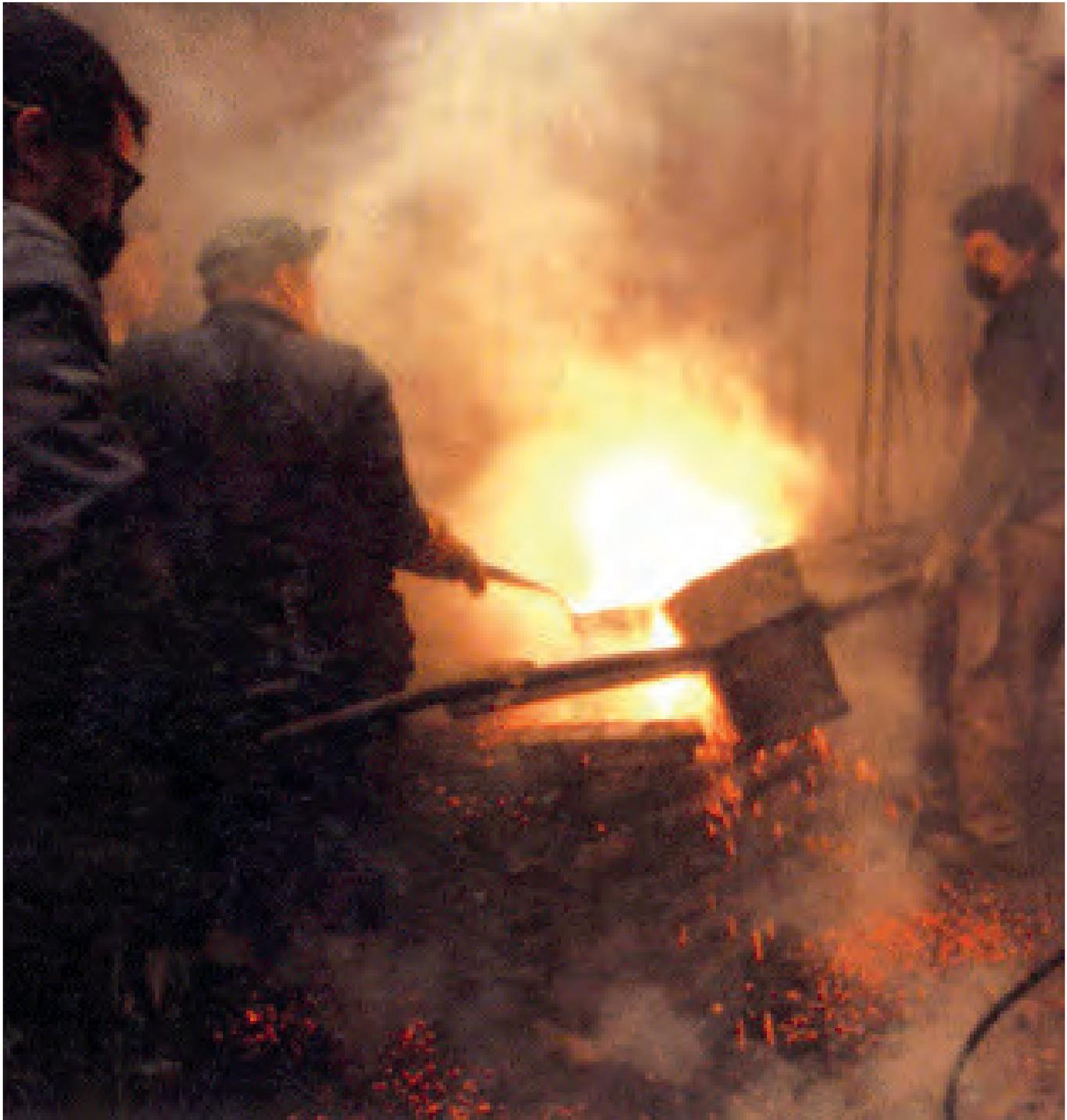
La cera rivestita viene messa in un forno ad alta temperatura (shock termico) in cui il refrattario si cuoce in breve tempo e la cera volatilizza completamente (cera persa). Si ottiene così un negativo in materiale refrattario, e nella cavità lasciata libera dalla cera viene colato il bronzo fuso.
